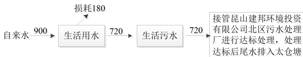
图 2-1 项目水平衡图 (t/a)
