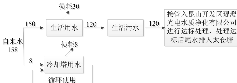
图 2-1 扩建项目水平衡图 (t/a)
